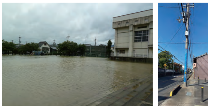
<写真左> 2013年9月の豪雨では木津川支流の小川が氾濫、運動場が冠水した <写真右> 「想定浸水深」まで青く塗られた電柱
