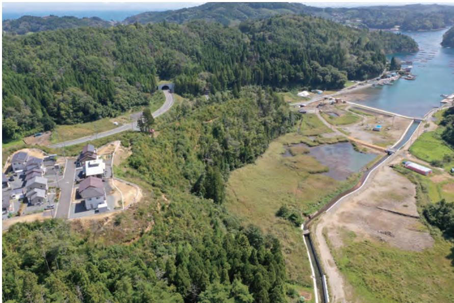
東日本大震災による被災後、住宅の高台移転により津波防災を確保し、沿岸低平地を汽水域として再生した宮城県気仙沼市舞根（もうね）地区
