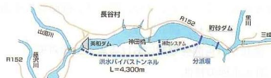
図3・2・11 洪水バイパストンネル等位置図
