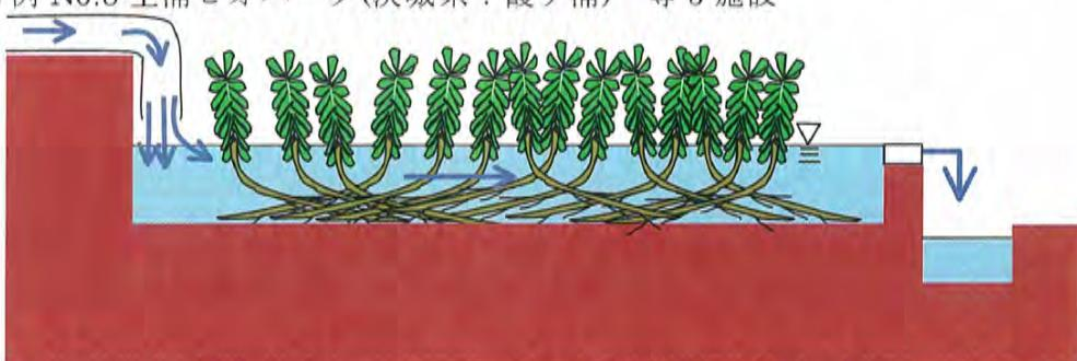
図 I -2-6 水耕法：直接植栽方式のイメージ
