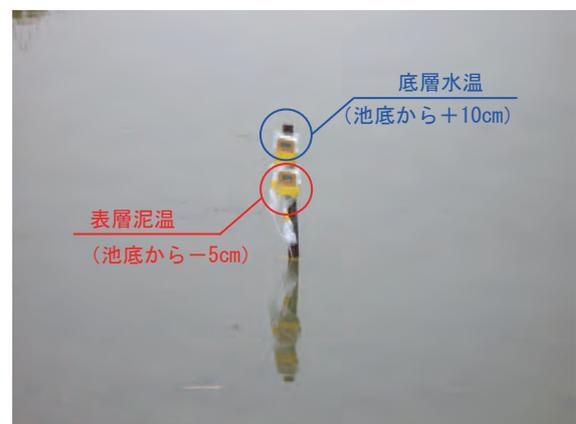
写真6・1 自記温度計の設置状況(H18年10月31日)
