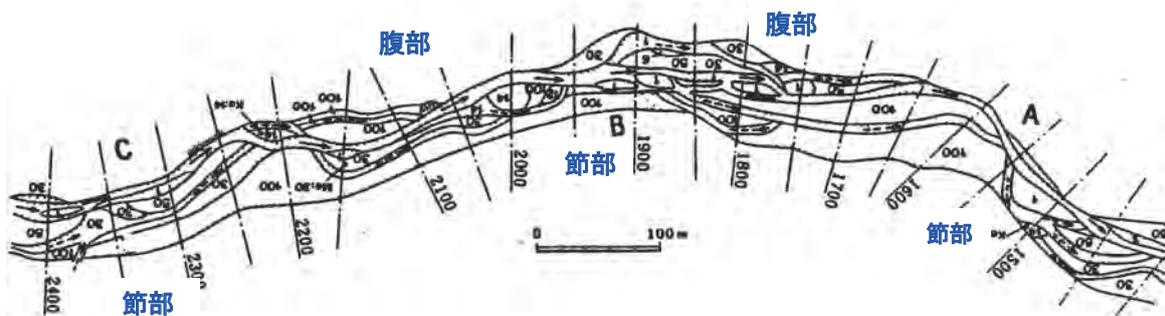
図2・4 大・中・小規模形態の重なり（白水川一部区間）。（上）主流部河床起伏。（下）流路平面形概要。
