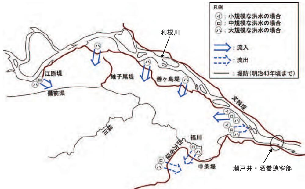
図 2-2 中条堤上流部における利根川洪水時のメカニズム
