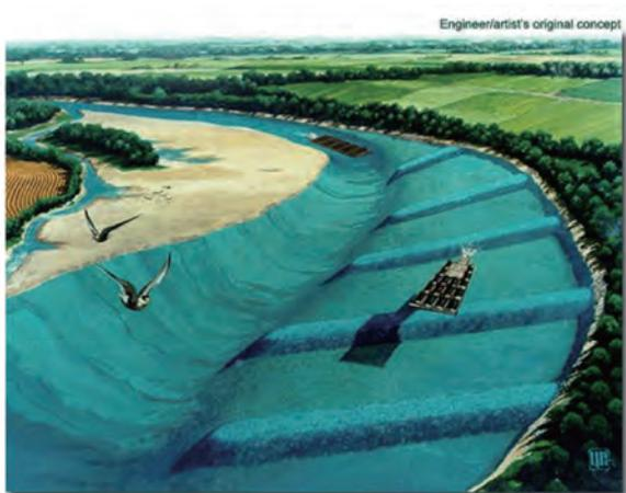
図 7・2 Bendway Weirs のイメージ<sup>8)</sup>
