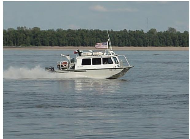
写真 8・1 河床形状超音波測量船<sup>9)</sup>
