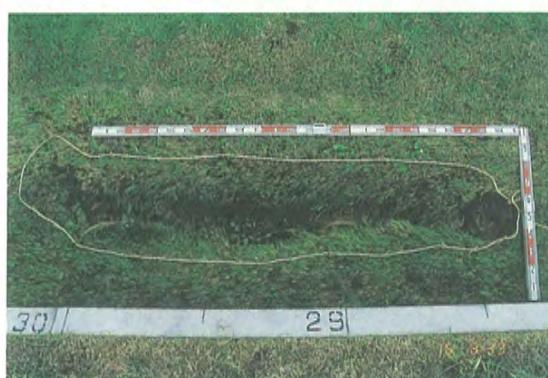
写真 10(3) 不織布なし水路円形損傷部の侵食進行状況
