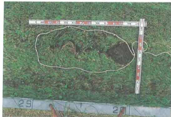
写真 10(1) 不織布なし水路円形損傷部の侵食進行状況
