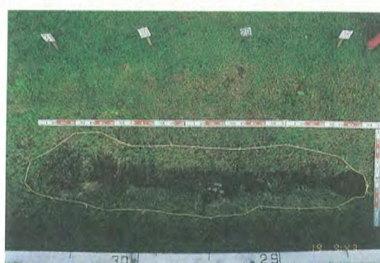
写真 10(4) 不織布なし水路円形損傷部の侵食進行状況
