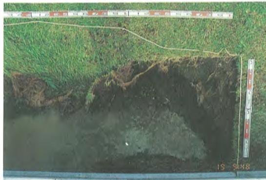
写真 11(3) 矩形損傷部の侵食進行状況の比較
