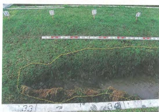
写真 9(5) 円形損傷部の侵食進行状況の比較
