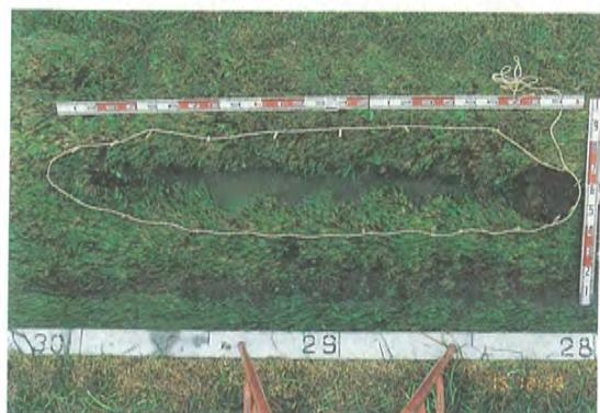
写真 10(2) 不織布なし水路円形損傷部の侵食進行状況
