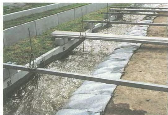
写真2 実験3の流況(流量  $0.65\text{m}^3/\text{s}$ )
