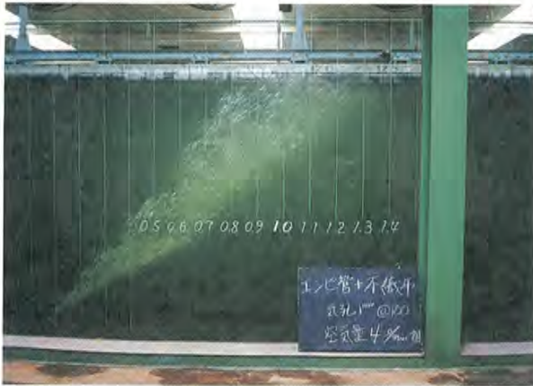
② 塩ビ管+不織布 気泡の上昇状況
