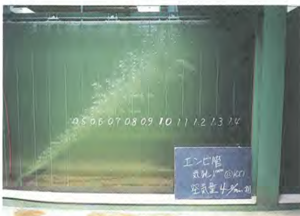
① 塩ビ管 気泡の上昇状況
