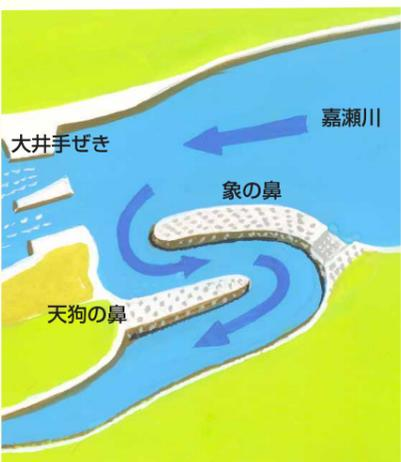
大井手堰は水の流れを受けとめ流れを変え、象の鼻・天狗の鼻で水の流れをゆるやかにして土砂を沈ませ、石井樋にみちびく役目をします。
