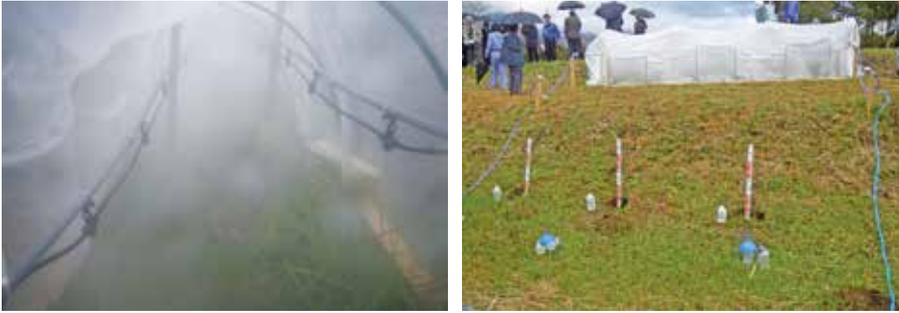
図11 人工降雨による植物成長調整剤の流出有無を確認した実験
