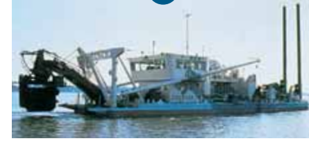
写真⑭ 茨城県霞ヶ浦の水質浄化に活躍する浚渫(しゅんせつ)船「カスミザウルス」。霞ヶ浦では、湖の底にたまった泥(底泥)から溶け出すチッソとリンが非常に多い。そこで浚渫船を使って、泥を湖底からさらい(浚渫して)チッソとリンを除去している。泥は低地水田のかさ上げに利用されている。写真提供/国土交通省関東地方整備局霞ヶ浦河川事務所
