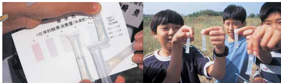
写真⑥ バックテストはCODを検査する簡便な方法。この方法で川の水質を調べている小学生や中学生もたくさんいる。
