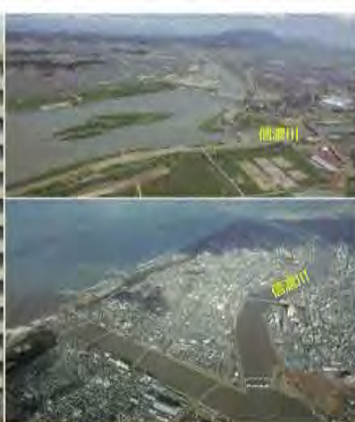
●大河津分水路（上、画面右に信濃川が流れる）と関屋分水路（下、信濃川は画面右上方に流れる）。大河津分水路と関屋分水路の整備により新潟市をふくむ信濃川下流域の水害は大幅に減少した。[上の写真提供／国土交通省信濃川下流河川事務所。下の写真提供／国土交通省信濃川下流河川事務所]
