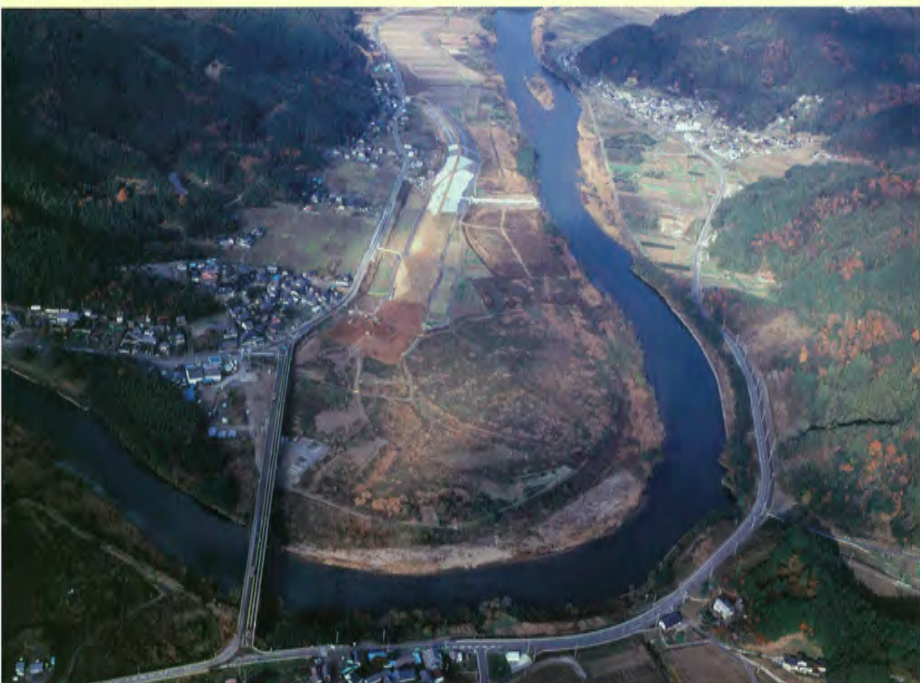
●京都府北部を流れる由良川では、人家が連なる区域は堤防でまもり、田畑は浸水を許容する治水対策が進められている。[写真提供/国土交通省近畿地方整備局福知山河川国道事務所]
