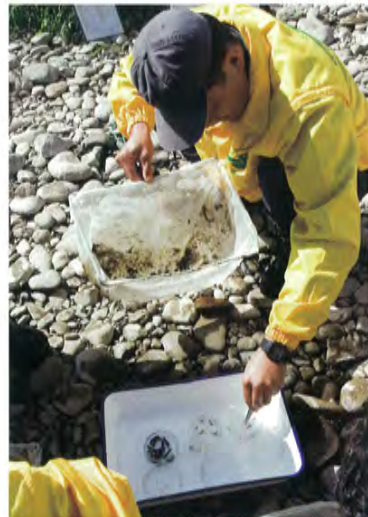
●網で川底をすくい石の裏などにすむ水生生物で水質を調査する。
