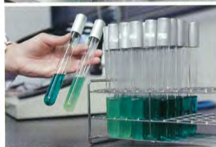
写真⑦ 川の水に病原性微生物がふくまれているかどうかの指標として、よく使われる大腸菌の検査は専門家が実験室で行っている。川の水を入れた試験管に現れる気泡が大腸菌群である。
