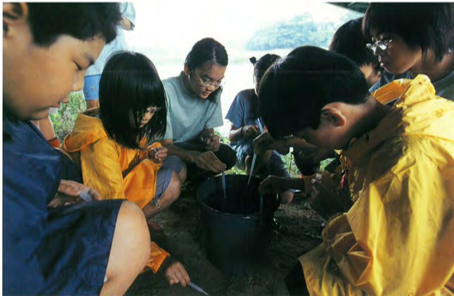
●試験水が1.5ml 入る専用容器に水を移すスポイトの先を、まず、試験水で洗う。
