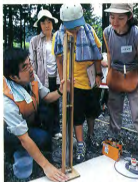
写真② 水の透明さ(透視度)を調べるには透視度計が使われる。底の十字マークが見えなくなる高さを、その水の透視度にする。ここで使われているのは1mの透視度計。
