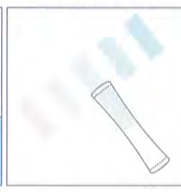
図② バックテストの使いかた 試薬の入ったバックに小さな穴を開け、なかの空気を抜いたら、調べる水(試験水)をバックに吸いこむ。そのとき水温に合わせて、一定時間そのままにしておき、色が変わったところで添付の標準色表とくらべる。
