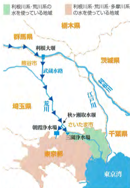
図④ 東京都民の水道の長い旅 1200万人の東京都民の暮らしを支える水のために、東京都を流れる多摩川だけではなく、群馬県と埼玉県の境を流れている利根川から、埼玉県を遡って東京まで水を引いてきている。資料提供/東京都水道局
