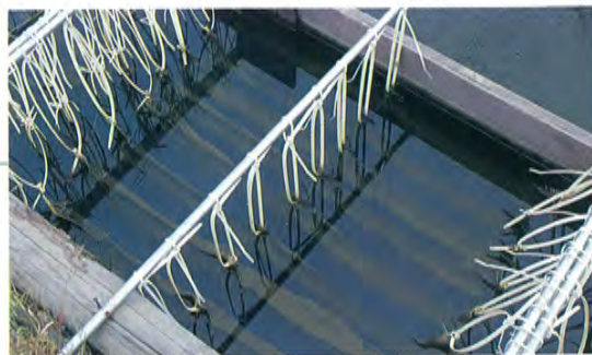
● 繊維物接触材浄化実験
