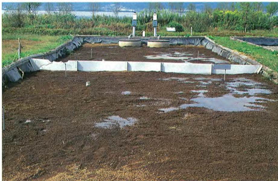
●土壌浄化実験施設。4つの槽があり赤玉土や黒ボク土、礫をつかって浄化する。この槽は赤玉土を濾材(ろざい)に実験している。遠くに琵琶湖の湖面が見える
