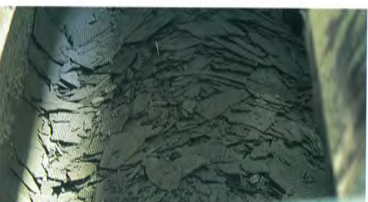
●フロックが装置の底に沈殿してできる固まり(スラッジ)は脱水され板状の「ケーキ」にされる。このあと、廃棄物として処理される
