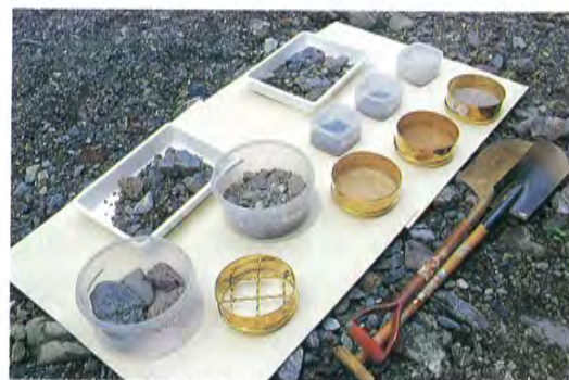
●河床材料は、目の違うふるいでより分け重量比を調べる
