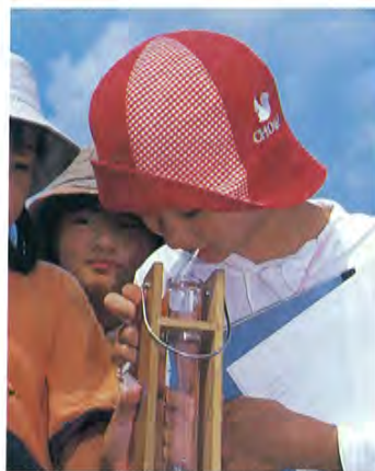
●100cmの透視度計で透視度を調べる
