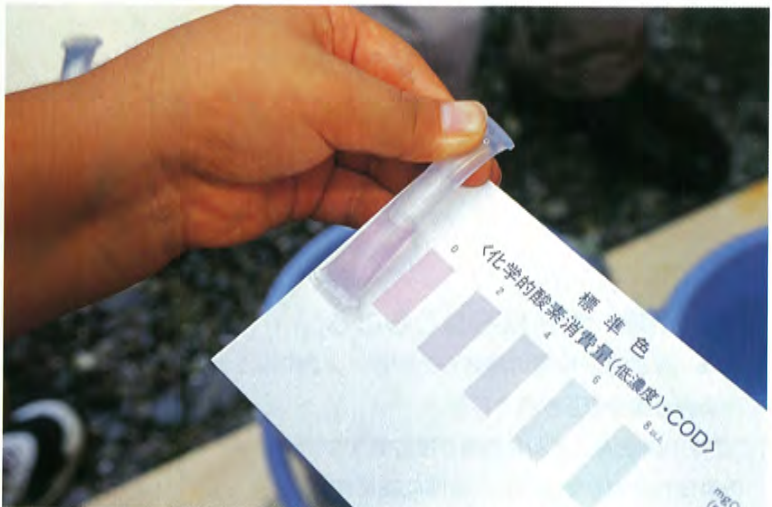
●バックテストでCOD(化学的酸素要求量)を測定。はじめてのバックテストに隊員たちはとても楽しそう。上流では0~2mg/lできれいだった
