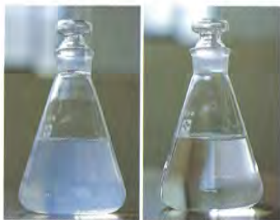
●高速凝集沈殿池で薬品を注入した原水(左)と処理後の水(右)
