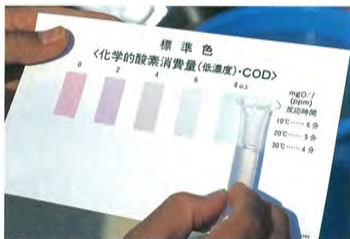
●COD検査。 バックのなかの水の反応色を標準色と比較して数値を決める
