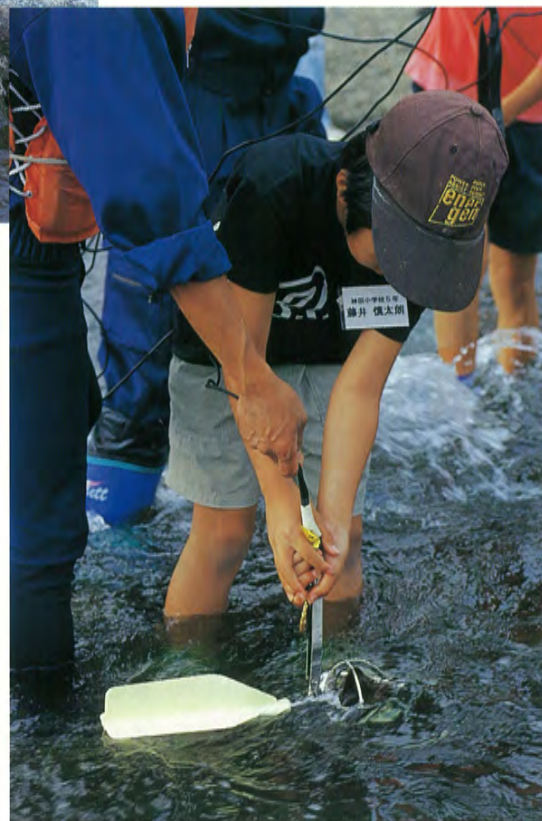
●上・左：流速計をつかって流速を調べる
