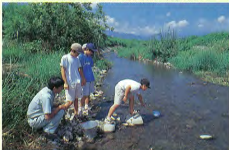
●バケツで運んだサンプル水をバックテストで調べる
