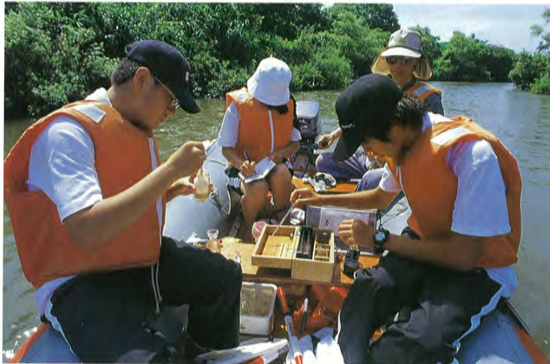
●旅館での測定のためにポリタンクに採水。採水は流れの中央で行う
