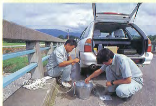
●塩尻市職員による奈良井川の水質調査。堅石橋からバケツを川に投げ入れ、その場でバックテストを行う(53ページ i-2 地点)
