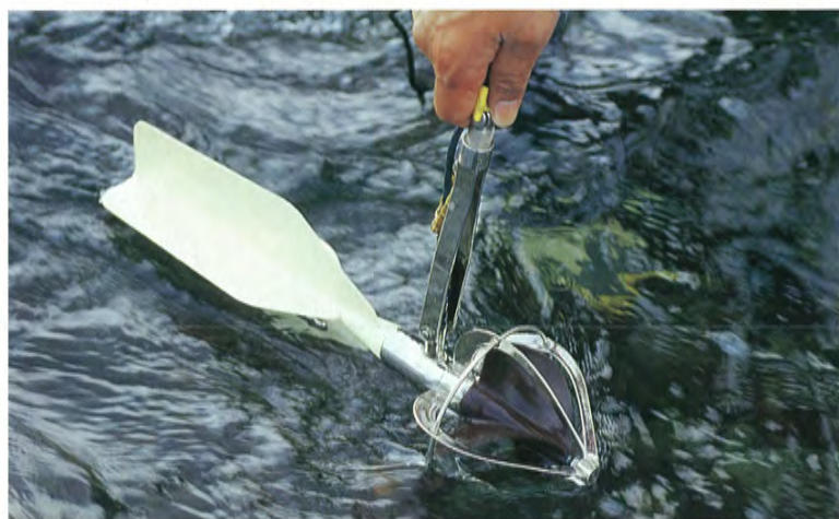
●上・左：流速計をつかって流速を調べる
