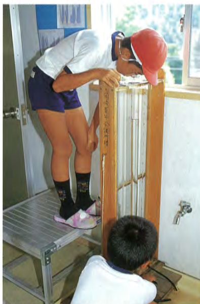
●透視度計でその日の透視度を測る
