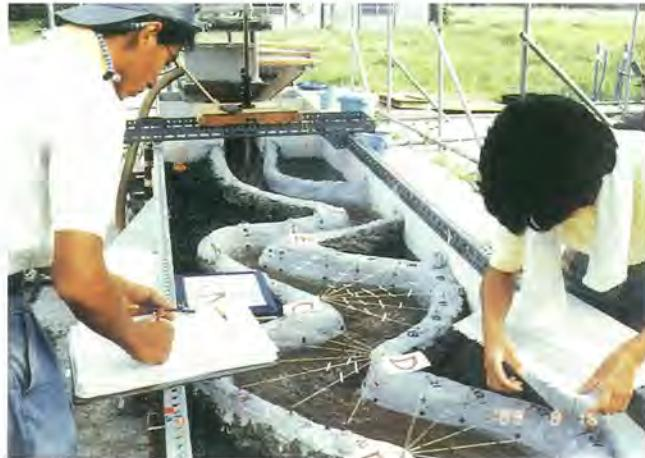
写真－3 蛇行河道湾曲部における河原の形成に関する模型実験
