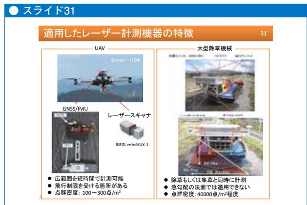
ところですが、後ろ側には測量ユニットが取り付けられています。レーザスキャナとデジタルカメラを装備し、車両直下の地形を計測します。当たり前かもしれませんが、この機械は、法面を計測するのが得意です。除草もしくは集草しながら、同時に地形を計測できるという機器です。国土交通省では、年2回の除草をしていますので、堤防除草の折にこの機械に付けておくだけで同時に地形を計測することができます。出水期前後で除草しますので、出水を受けての変化を把握するのにも有効です。
